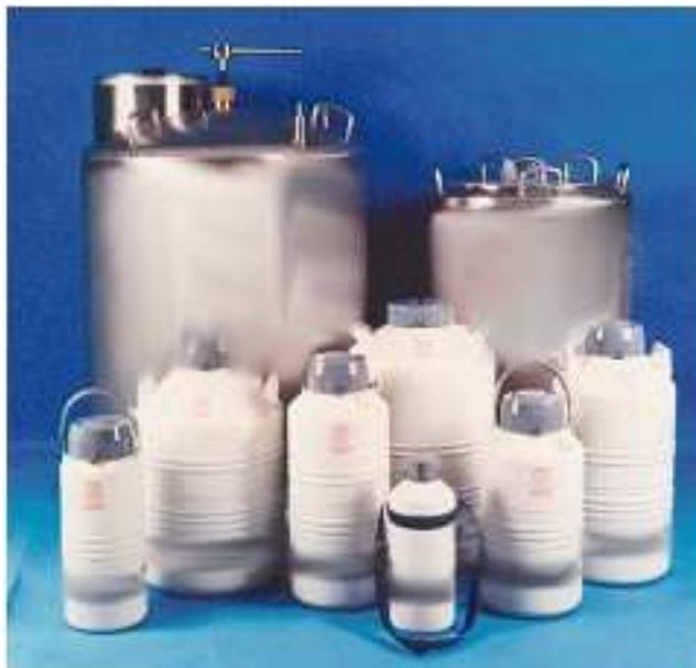
**Figure 4: Photographie des différents types de récipients de stockage de produits biologiques en immersion dans l'azote liquide**
