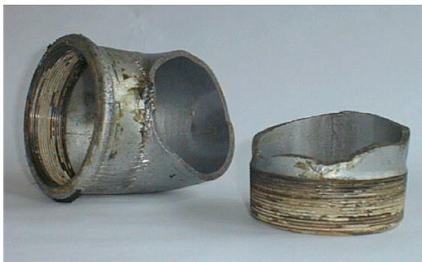
**Figure 1 : Rupture de fragilité d'un raccord inadapté aux basses températures**
